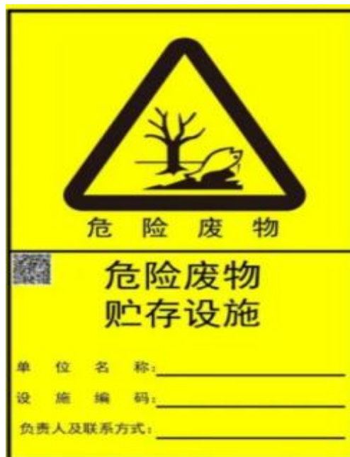
图 4.9-1 危废暂存间标识标牌示例（粘贴或悬挂于门上）
