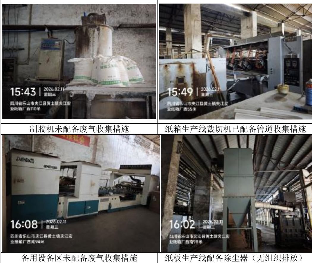
图 3.6-2 技改前纸箱生产车间粉尘收集和处置措施照片
