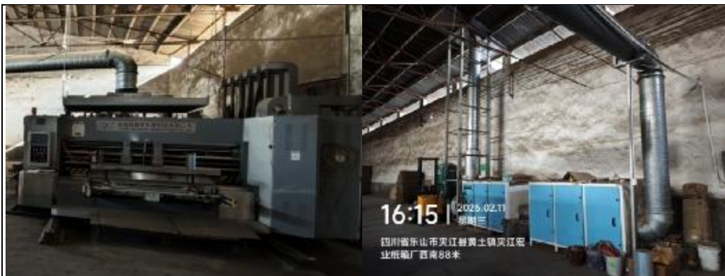
印刷机上方已设置集气罩
