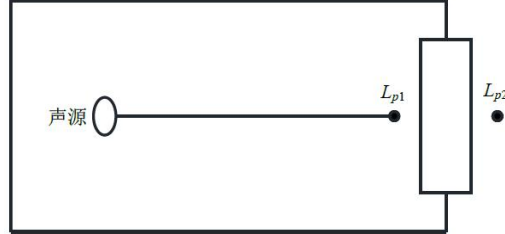
图 4-1 室内声源等效为室外声源图例
