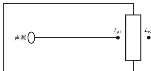
图 4-8 室内声源等效为室外声源图例
